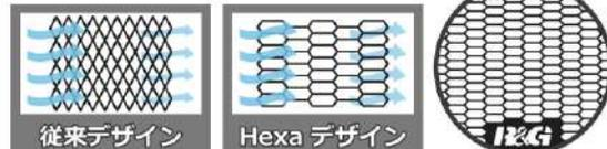
従来デザインよりも空気の流れが良く冷却効率を落とすことなくご利用いただけます。
